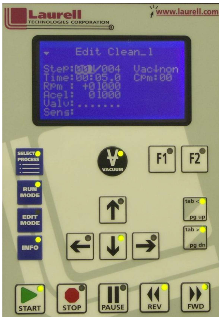
Obr. 13.: Mód „EDIT MODE“; (obrázek použit s laskavým svolením firmy Laurell Technologies Corporation)
