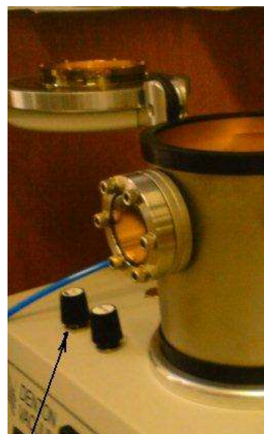
Obr.5.: Šipka ukazuje na jehlový ventil, kterým lze zvýšit nebo snížit přítok argonu a tím měnit pracovní tlak v komoře
