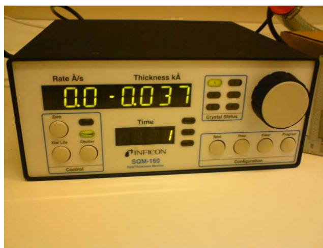
Obr.9.: Krystalová měrka po spuštění procesu naprašování
