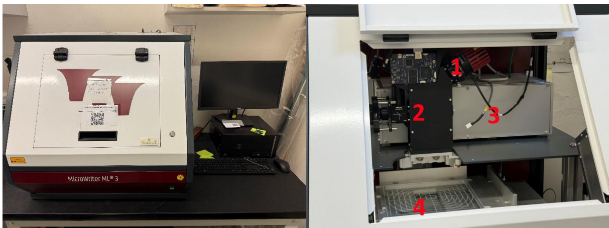
Obrázek 3: Litograf zvenku s připojeným počítačem (vlevo) a jeho vnitřní konstrukce (vpravo).
