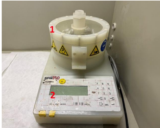
Obrázek 2: Spincoater skládající se z pracovní komory (1) a řídicího panelu (2).
