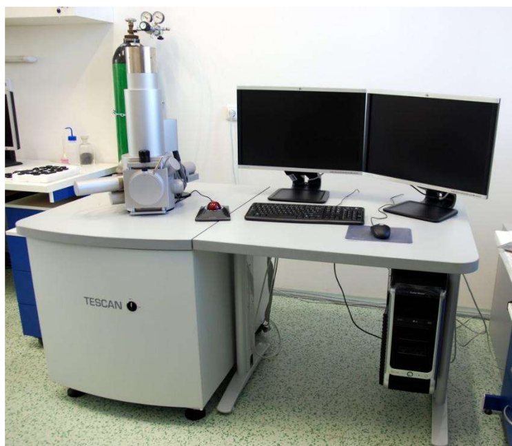
Obr. 3: Skenovací transmisní elektronový mikroskop Vega 3SBU od firmy Tescan
