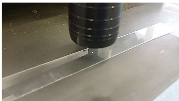
Obr. 4: Detail na senzor, světlá tečka je zaostřené polychromatické světlo
