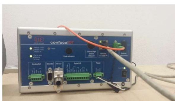
Obr. 3: Oba indikátory musí během měření svítit zeleně.
